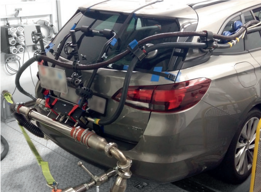
Abgas- und CO 2 -Messung eines Fahrzeugs im Labor. Die Ausrüstung für die Strassenmessung ist ebenfalls bereits montiert.
